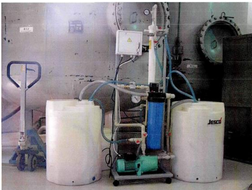
Рис. 4. Экспериментальная установка для исследования процессов ультрафильтрации
